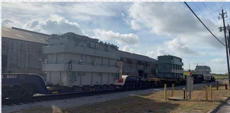
Railway transportation for 3sets of 345kV 700MVA、232kV 510MVA、232kV 224MVA.
