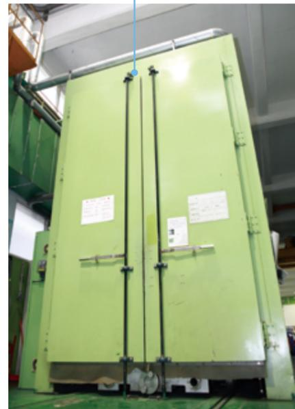
變壓器線圈烘乾爐
